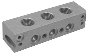
L'intermedio è utilizzabile per dividere una batteria di valvole in due parti e immettere l'aria per l'alimentazione di una delle due attraverso le connessioni di cui è dotato, e/o per dividere in due parti gli scarichi convogliati. È venduto con i pezzi necessari al suo assemblaggio.
