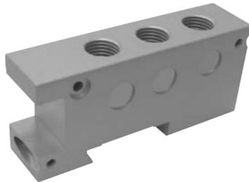
L'intermedio è utilizzabile per dividere una batteria di valvole in due parti e immettere l'aria per l'alimentazione di una delle due attraverso le connessioni di cui è dotato, e/o per dividere in due parti gli scarichi convogliati. È venduto con i pezzi necessari al suo assemblaggio.
