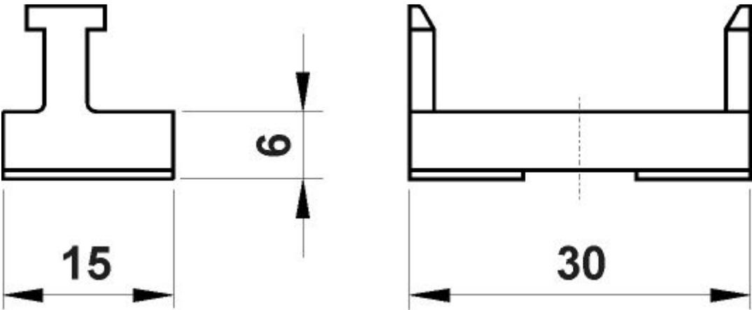
**08.015.2** двойной адаптер (с винтами) для ручного управления на монтажной панели
