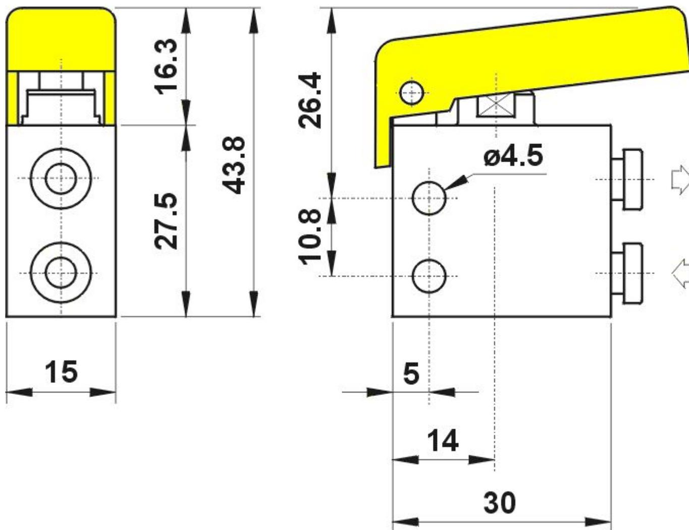
**304 MGV UL** распределитель 3/2 нормально закрытый, с клавишным рычагом, соединения с цанговым зажимом для шланга с наружным диам. 4 (отверстия на боковой стороне корпуса), цвет рычага - **ЗЕЛЁНЫЙ**
