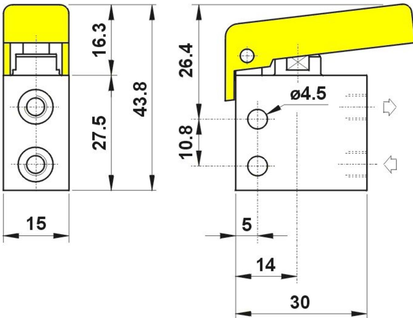
**305 MGV UL** распределитель 3/2 нормально закрытый, с клавишным рычагом, резьбовые соединения М5 (отверстия на боковой стороне корпуса), цвет рычага - **ЗЕЛЁНЫЙ**
