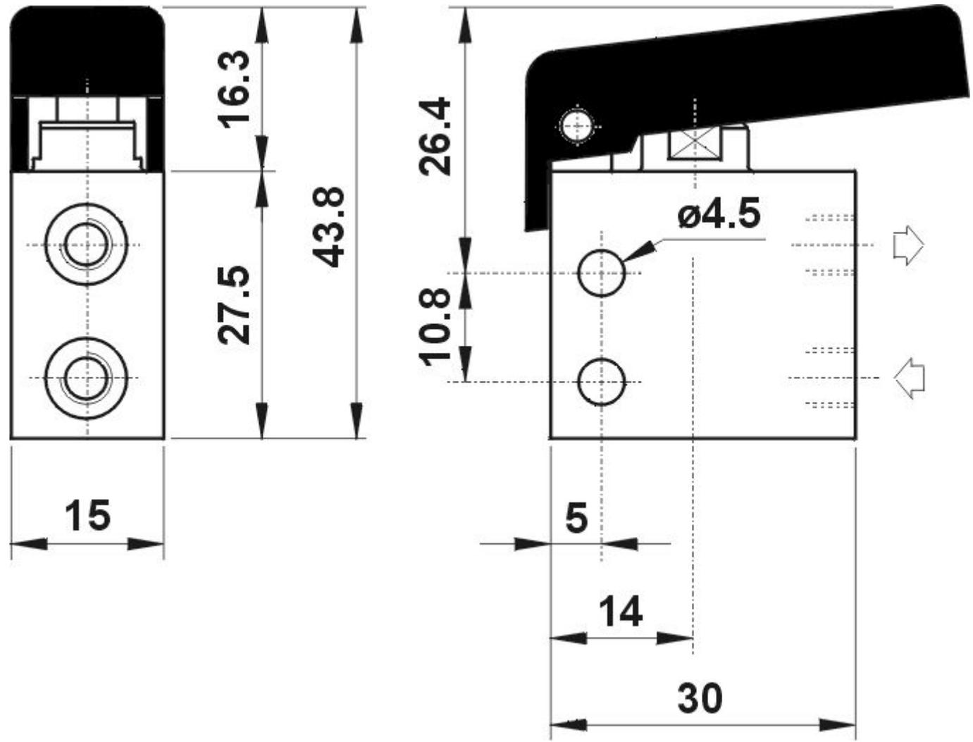
**305 LL** распределитель 3/2 нормально закрытый, тумблер, резьбовые соединения M5 (отверстия на боковой стороне корпуса), корпус из никелированной латуни
