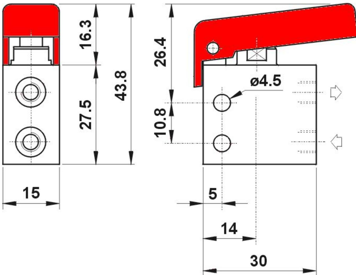
**305 MGG UL** распределитель 3/2 нормально закрытый, с клавишным рычагом, резьбовые соединения M5 (отверстия на боковой стороне корпуса), цвет рычага - **ЖЁЛТЫЙ**
