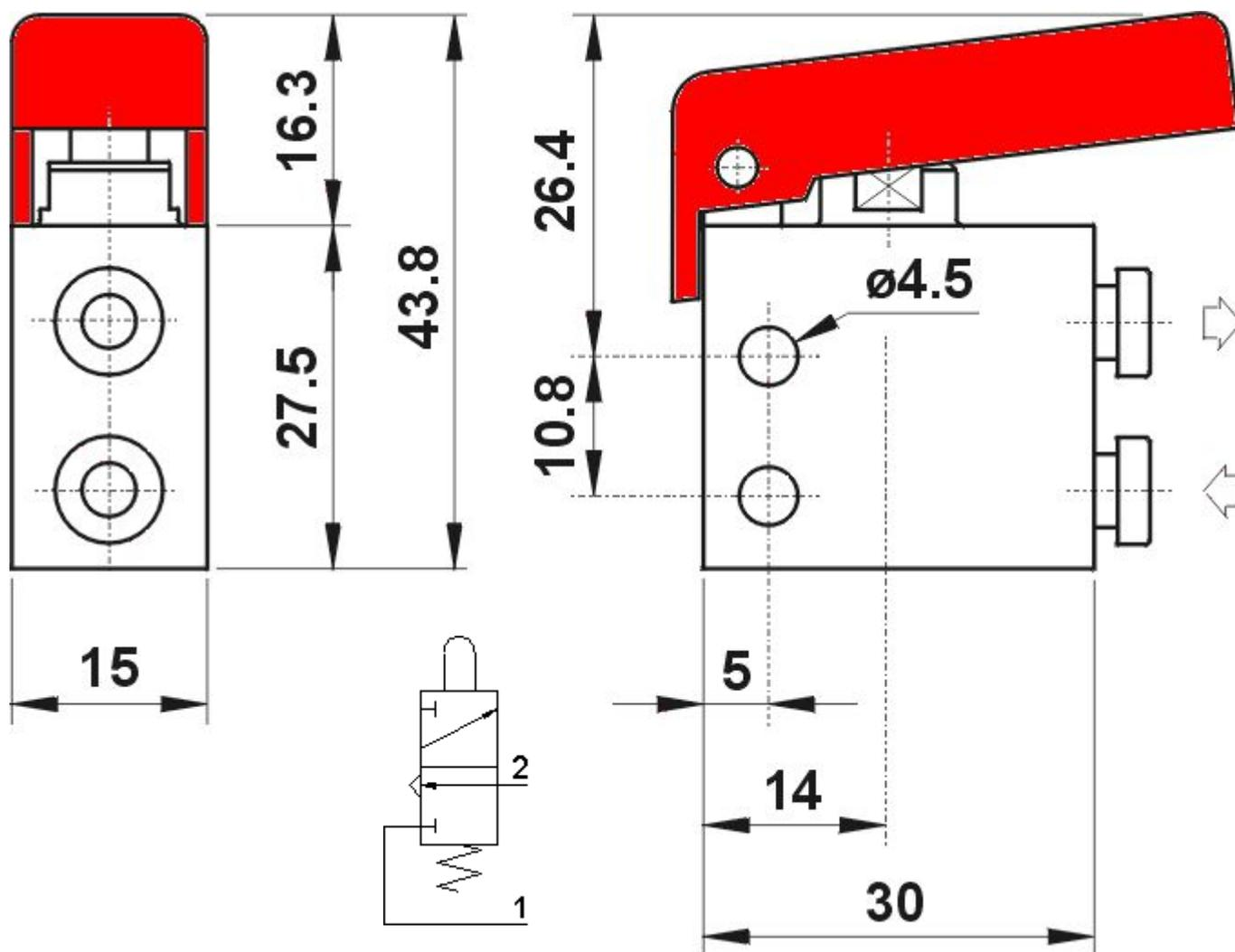
**304 MGG UL** распределитель 3/2 нормально закрытый, с клавишным рычагом, соединения с цанговым зажимом для шланга с наружным диам. 4 (отверстия на боковой стороне корпуса), цвет рычага - **ЖЁЛТЫЙ**
