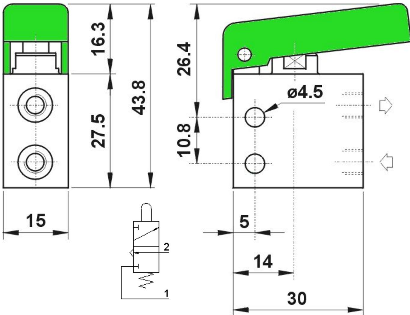
**305 MGN UL** распределитель 3/2 нормально закрытый, с клавишным рычагом, резьбовые соединения M5 (отверстия на боковой стороне корпуса), цвет рычага - ЧЁРНЫЙ
