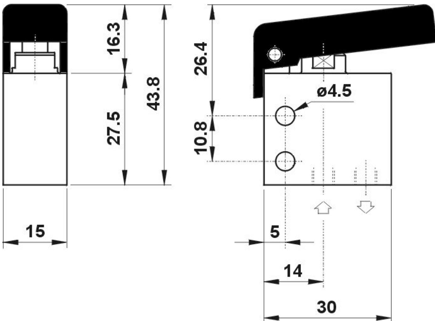
**305 MGR UL** распределитель 3/2 нормально закрытый, с клавишным рычагом, резьбовые соединения М5 (отверстия на боковой стороне корпуса), цвет рычага - **КРАСНЫЙ**
